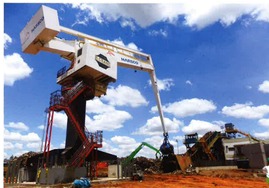
Afb. 1 De E-Crane kranen zijn ontworpen op basis van het balansprincipe
