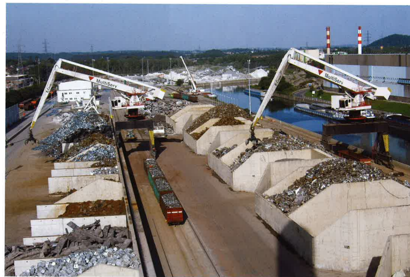
Afb. 2 E-Crane overslagkranen bij schrootverwerker MultiServ
